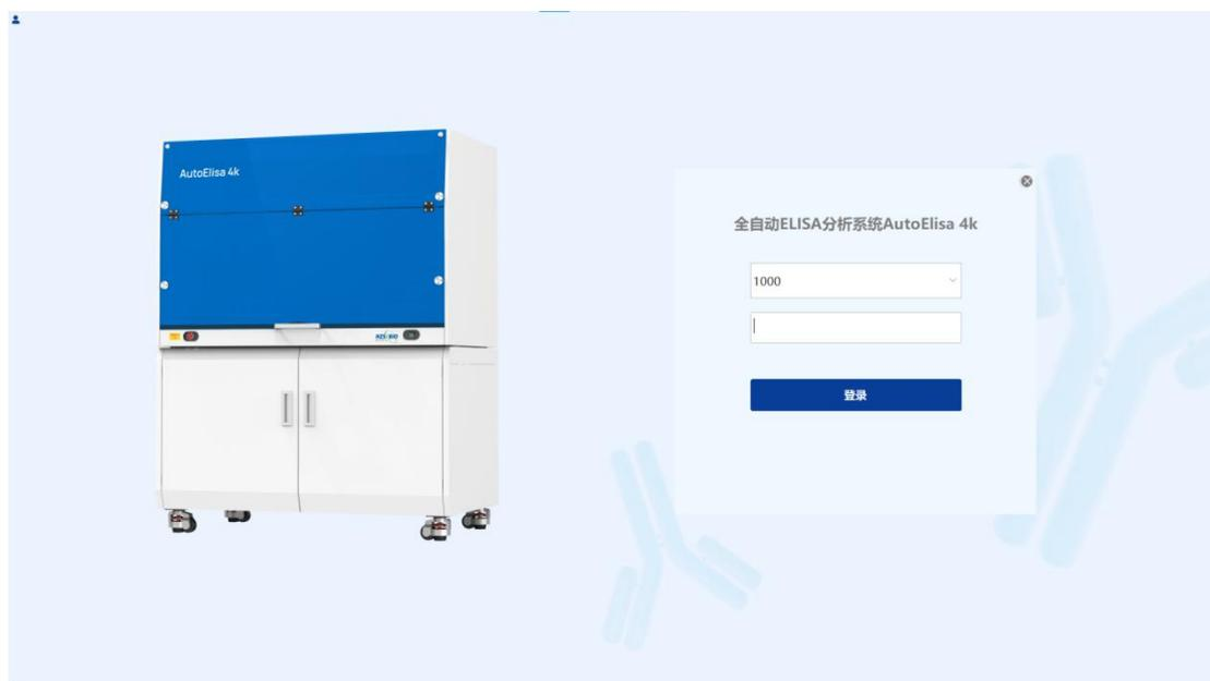
2. 每日第一次使用前需进行设备初始化, 点击“确认”后, 页面显示“自检完成”。同一天其他阶段打开可选择不进行初始化。
